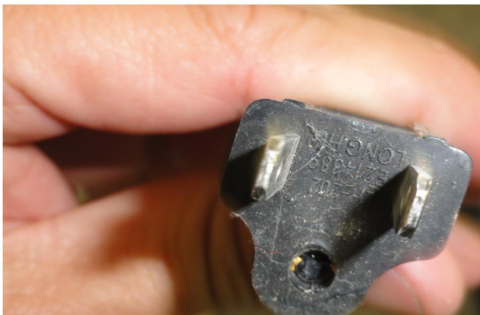
Foto 22: Cable de regleta con conexión a tierra quebrado en laboratorio CU Palmares.
